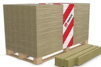
Ламель PAROC COL 20 - это негорючая каменная вата, для конструкций из сборного железобетона и конструкций, требующих особой несущей способности материала. Прочность на сжатие при 10% деформации – 20 кПа. Ламель обладает превосходными щелочестойкими характеристиками. Она не накапливает влагу и не теряет своих свойств при изменении температуры.
